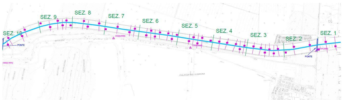
Figura 51 – Ubicazione dei capanni, delle sezioni trasversali del rilievo topografico e di quelle aggiuntive, utilizzate per la modellazione specifica dell’effetto dei capanni, nel tratto terminale del fiume Lamone.
