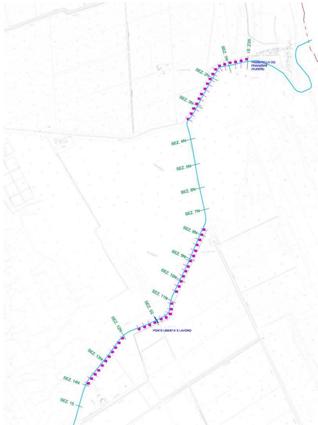
Figura 55 - Ubicazione dei capanni, delle sezioni trasversali del rilievo topografico e di quelle aggiuntive utilizzate per la modellazione specifica dell'effetto dei capanni, nel tratto terminale del torrente Bevano.
